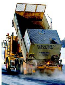
Ny teknik för sandning: FrictionMaker, som blandar sand med hetvatten, vilket fryser fast på vägytan och ger god friktion samtidigt som det är miljövänligt.
